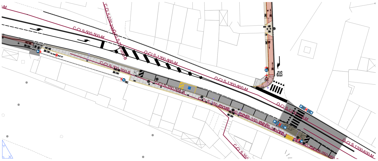
Via Unità d'Italia, presenza rete fognaria presso il marciapiede oggetto di intervento
